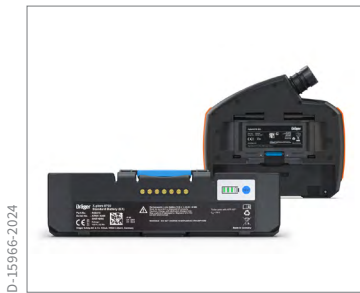
교체형 배터리에 있는 스마트 디스플레이로 충전 상태 확인
